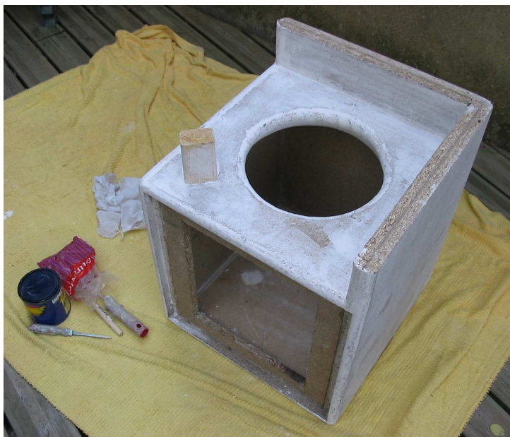
Lissage de la surface (le caisson est posé à l'envers)
